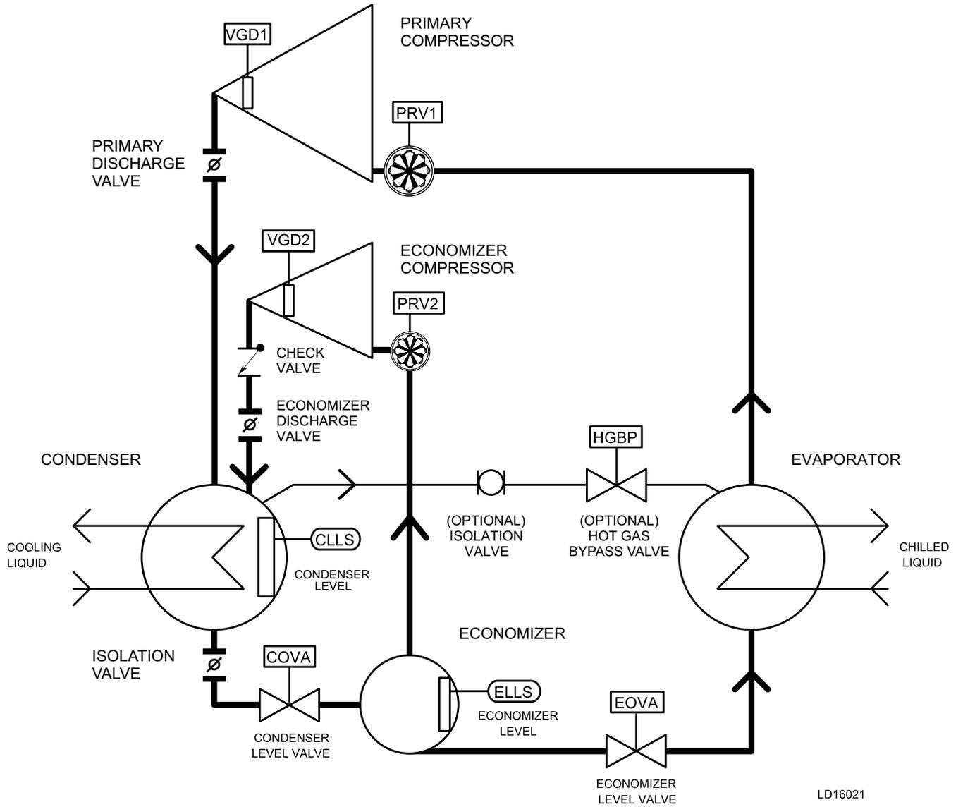
**FIGURE 8 - REFRIGERANT INSTRUMENTATION DIAGRAM**
